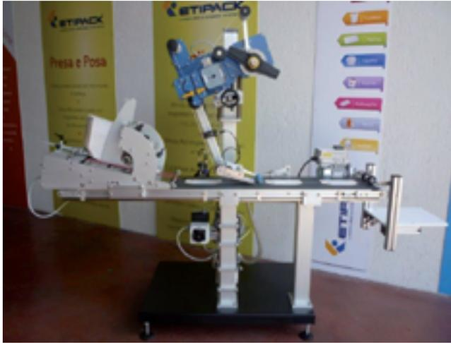
Sistema 9 Light è un sistema di etichettatura automatico studiato per movimentare ed etichettare prodotti stesi quali buste, fustellati, riviste e pieghevoli con formato massimo A4. Nella configurazione proposta il sistema applica etichette a radiofrequenza con funzione di antitaccheggio all'interno di fustellati.
