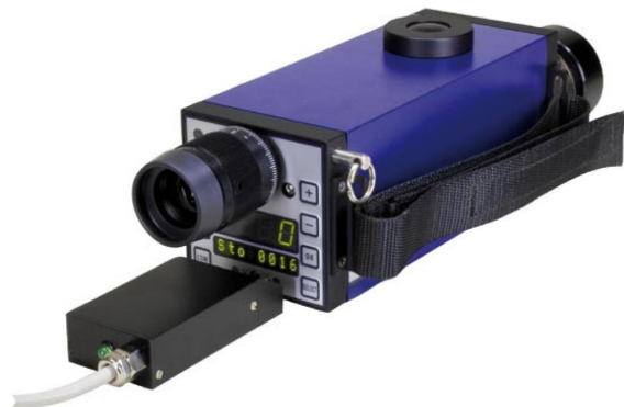
KG 315 - K USB mit Infrarotschnittstelle zum Auslesen der Daten
