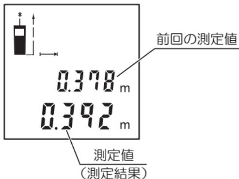
5.測定を続けるときは、再度モード切換ボタン（
