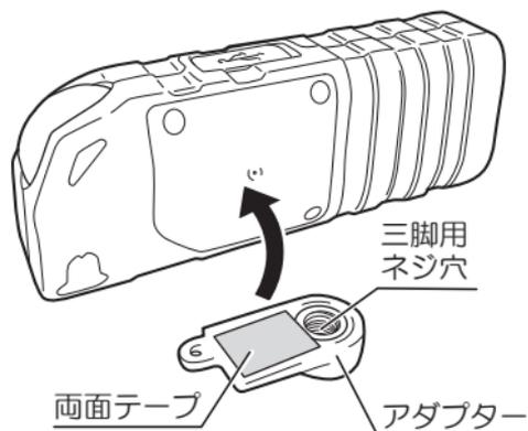
2. アダプターの三脚用ネジ穴を使用して、市販の写真撮影用三脚を取付けます。
