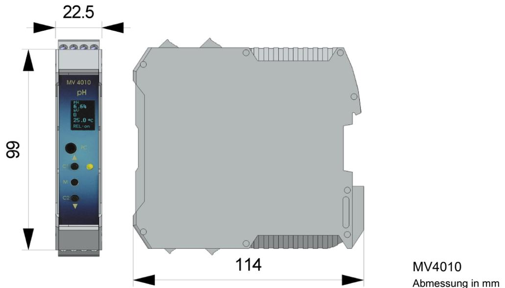
Eine kleine OLED-Anzeige für Messwert und Kalibrieranweisungen erleichtert Kontrolle und Service vor Ort. Die programmierbaren Kalibrierfunktionen, Temperaturkompensation, einfache Installation und Programmierung mittels PC-Schnittstelle zeichnen die Messverstärker aus. Die Messverstärkerserie gewährleistet zuverlässig die simultane Messung von:
