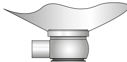
Utilizzare solo la saldatura ad arco pulsato e non lasciare spazi tra flangia e piastra del serbatoio. Saldare a punti sempre sul lato opposto (8 segmenti con metallo d'apporto). Saldare la radice se possibile senza metallo di apporto. la saldatura finale deve essere eseguita in 8 segmenti per evitare crepe.
