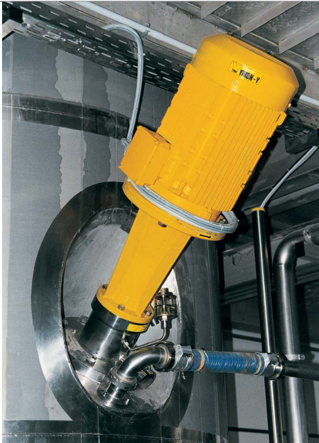
YTRON -Y ByPass in Tankflansch-Ausführung, Einbau im geschlossenen Behälter Aufgabenstellung: Shampoos und Duschbäder
