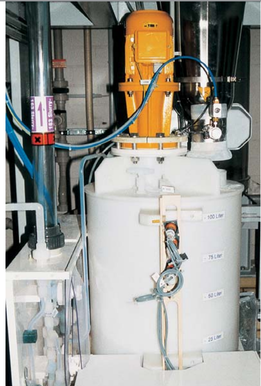
YTRON -Y auf Befestigungsflansch im offenen Behälter montiert Aufgabenstellung: Schleifmittelsuspension
