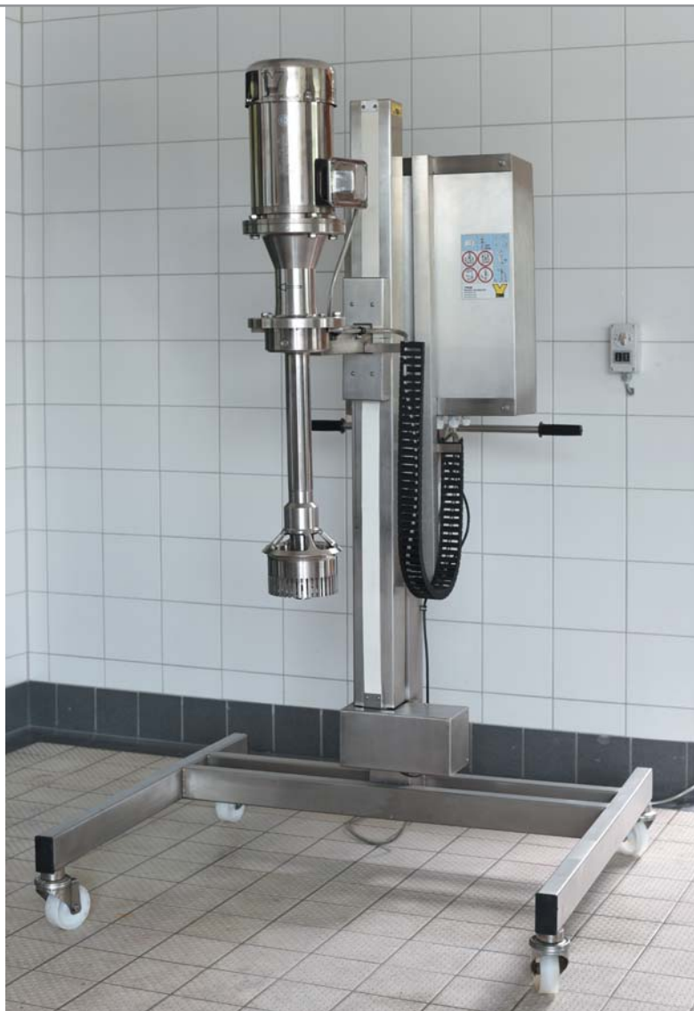
YTRON-Y Shear Jet, für den Eintrag von starken Scherkräften, mit Gleitringdichtung. Option mit fahrbarem Stativ.
