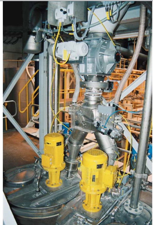
YTRON-Y ByPass in der Brauerei Aufgabenstellung: Suspensieren von Kieselgur Inertisierung mit CO 2 zur kontinuierlichen Entnahme
