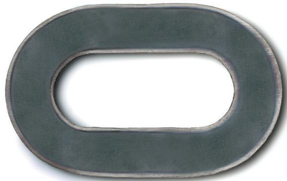
Längsschnitt durch ein einsatzgehärtetes Kettenglied
