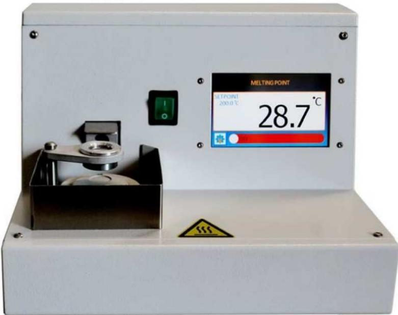
Strumento per determinare il punto di fusione di fibre e filati sintetici e per il riconoscimento degli stessi. L'apprezzamento avviene attraverso una lente di ingrandimento illuminata.
