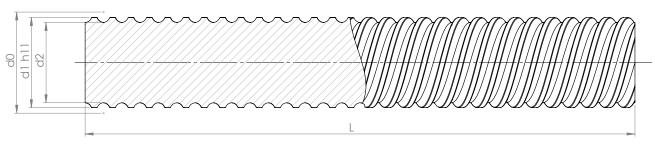
d0= Nenndurchmesser, d1= Außendurchmesser, d2= Kerndurchmesser, L= Spindellänge
