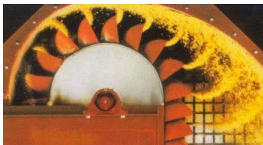
Gli elevatori sono costituiti da canne ed alla sommità hanno un pratico ballatoio per l'ispezione. Sono previsti portelli d'ispezione nei punti di carico e scarico del materiale. Le tazze possono essere richieste in polietilene o in acciaio stampato e sono imbullonate sul nastro di trasporto in gomma speciale a tre tele.
