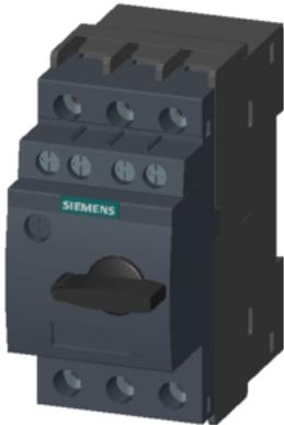
断路器 1.6 A A 脱扣器 1.1...1.6 A, N 脱扣器 21 A, 用于电机保护, 等级 10, 螺纹连接, 标准开关容量, 带横向辅助开关 1 NO+1 NC
