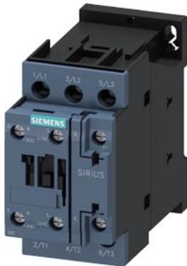
接触器 220 V AC 50/60 HZ AC3 11 kW 400 V 辅助触点 1 个常开触点 + 1 个常闭触点 3 极, 规格 S0 螺丝端子
