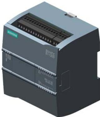
SIMATIC S7-1200, CPU 1212C, 紧凑型 CPU, DC/DC/DC, 机载 I/O : 8 DI 24V DC ; 6 个 24V DC 数字输出; 2 AI 0-10V DC, 电源: 直流 20.4-28.8V DC, 程序存储器/数据存储器 75 KB
