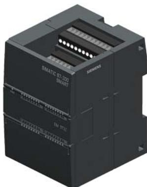
SIMATIC S7-200 SMART, 数字输入/输出 SM DT32, 16DI/16DO, 16DI 24V DC, 灌电流/拉电流, 16DO, 晶体管 0.75A
