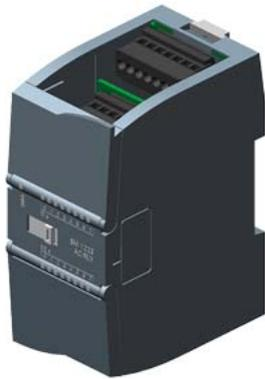
SIMATIC S7-1200, 模拟输入, SM 1231, 4 模拟输入, +/-10V, +/-5V, +/-2.5V, 或 0-20mA/4-20mA, 12 Bit+符号位 (13 Bit ADC)
