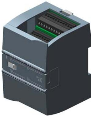
SIMATIC S7-1200, 数字量 I/O SM 1223, 16DI/16DO, 16DI 24V DC, 灌电流/拉电流, 16DO, 晶体管 0.5A
