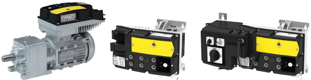
i550 motec变频器是最佳的分布式驱动解决方案,防护等级为IP66,适用于电机和墙式安装。该变频器可通过扩展盒(维护开关、控制元件)进行扩展,以实现通用目的。
