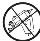
Halten Sie die Düsenspitze nicht nach oben. Andernfalls gerät heißer Schmelzklebstoff an den Deckel. Dies kann dazu führen, dass die Entlüftung verstopft sowie, dass heißer Klebstoff beim Öffnen des Gerätes austritt.
