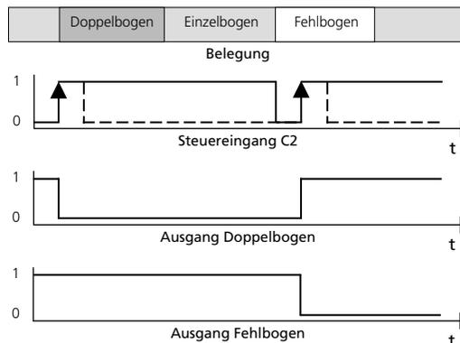
Abb. 7: Trigger-Mode flankengesteuert
