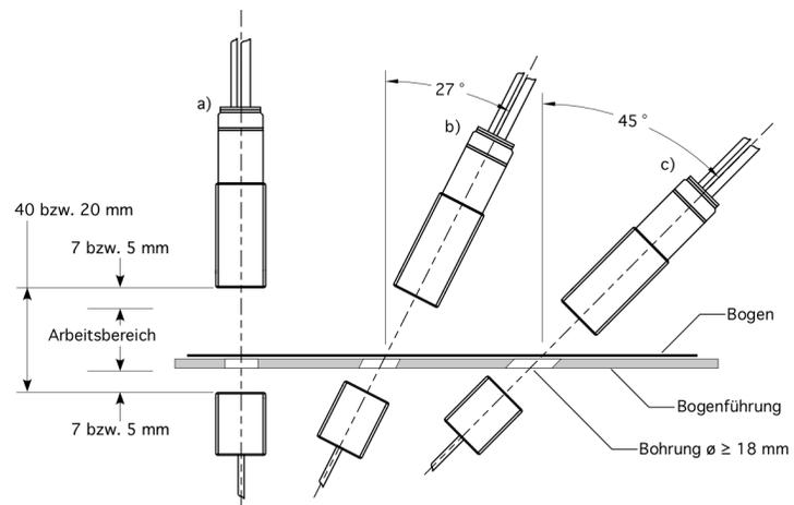
Abb. 1: Montage und Einbaulage zum abzutastenden Bogenmaterial
