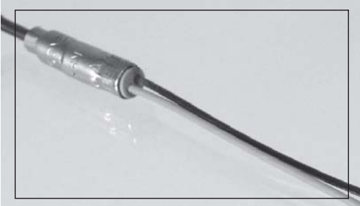
teflonisierte Litze PTFE insulated leads
