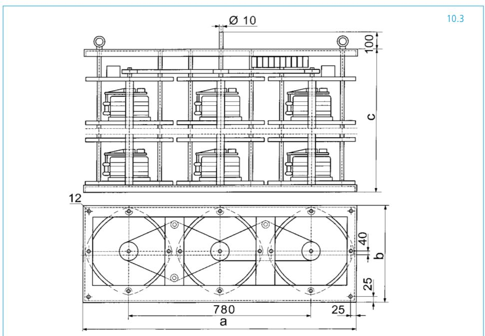
**Ringstelltransformatoren – 3-phasig mit Sparwicklung – Bauart YRVR mit steckbarer Welle**
