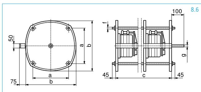
**Ringstelltransformatoren – 3-phasig mit Sparwicklung – Bauart YRV mit steckbarer Welle**
