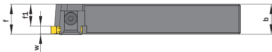
Maße f und w in Abhängigkeit der Schneidplatte Measures f and w depend on cutting insert
